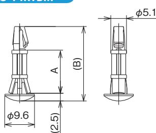
**薄板板金に対応した基板スペーサー****Dome-head, snap-mount spacer for thin panel or thin back plate****特長****Features**
