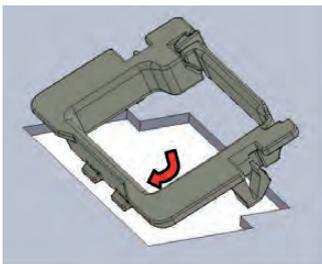
STEP.1 取付板の裏面に爪を引っ掛ける
