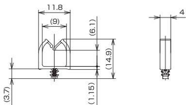
ネジ穴に差し込み固定できる小型配線クランプ
