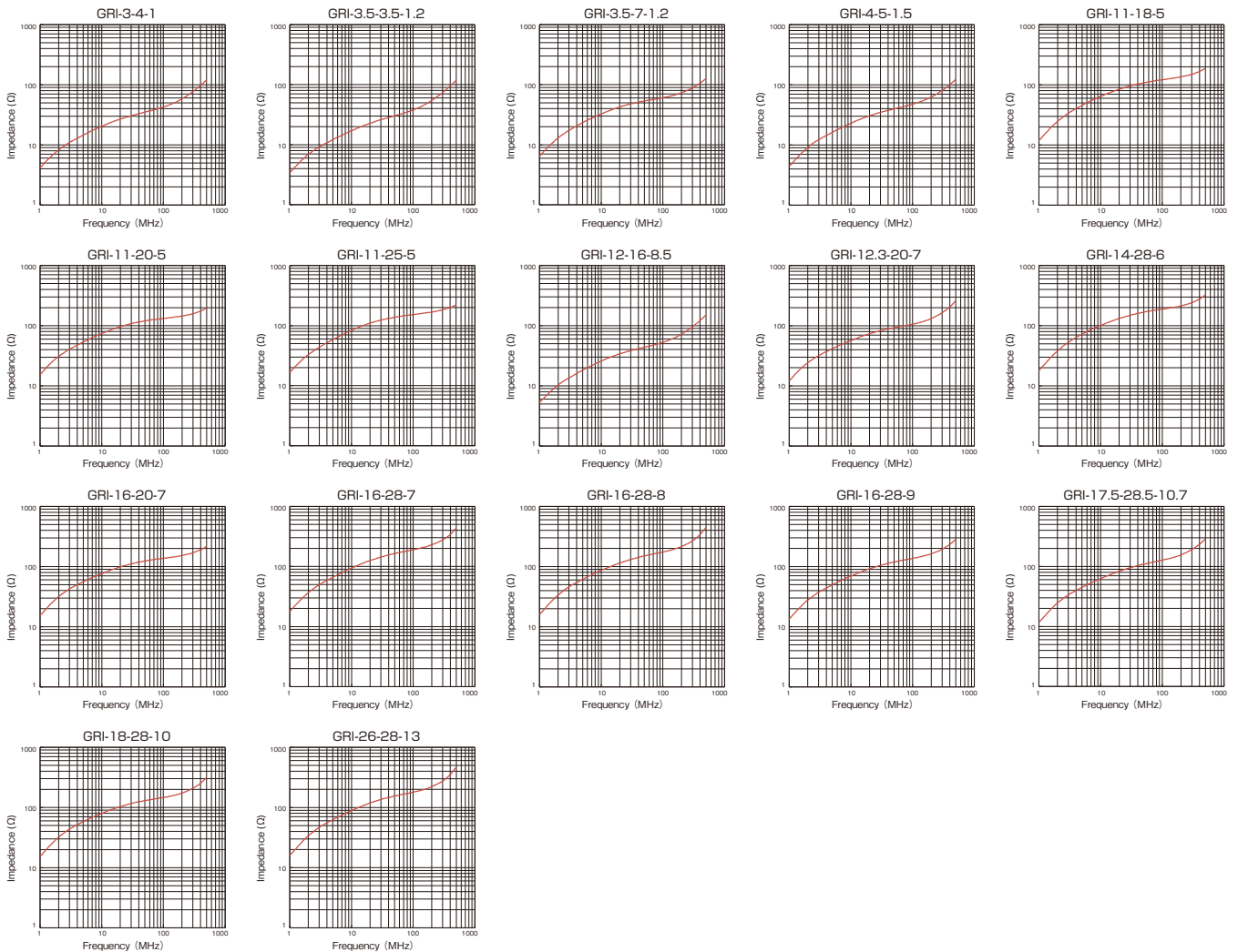
インピーダンス周波数特性 Impedance vs frequency
