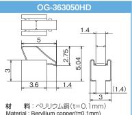
Material: Beryllium copper(t=0.1mm) 表面処理:Snリフローめっき(接点部Niめっき)
