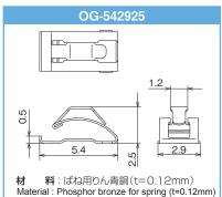
Material : Phosphor bronze for spring (t=0.12mm) 表面処理:部分Auめつき Surface treatment : Partial Au plating 使用範囲 : 製品高さ1.5~2.3mm(推奨) Recommended height : 1.5~2.3mm
